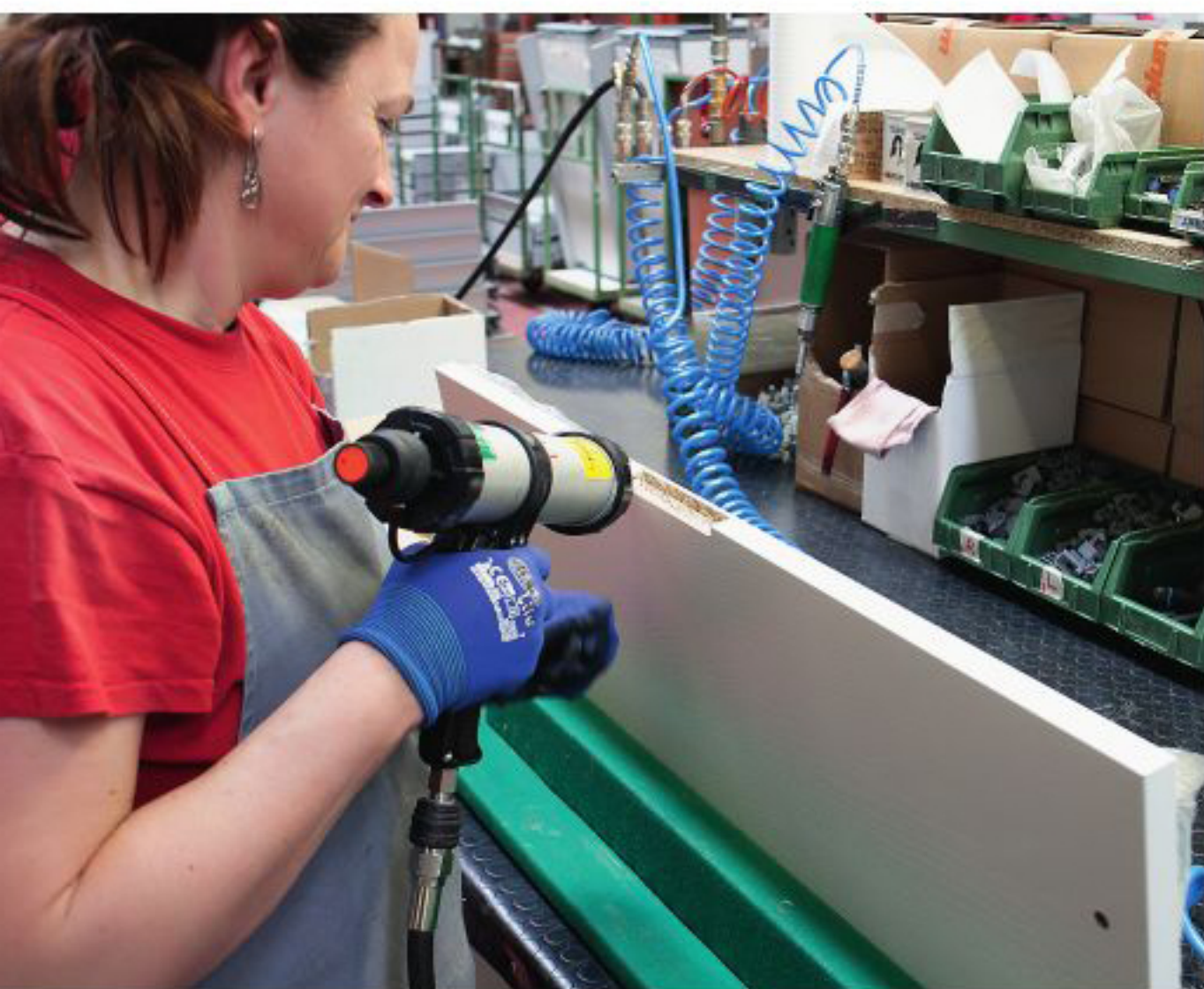
Слева: готовую панель обрабатывают силиконом, чтобы защитить от влаги.
